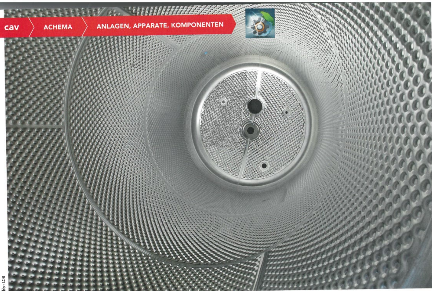
Blick in einen Rührwerksbehälter mit WTP-innen (unterer Klöpperboden)
