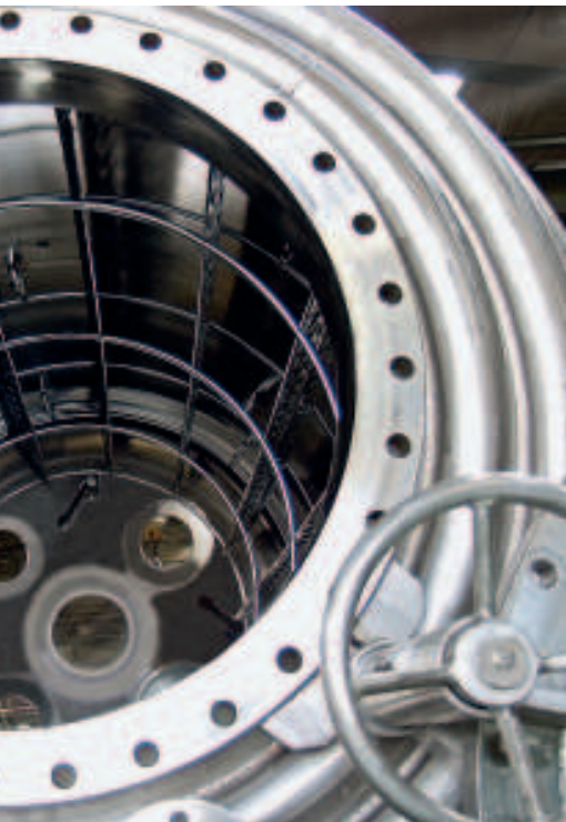
Die Verteilung des Wärmeträgermediums auf die Stromstörer erfolgt ebenfalls über einen zentralen Eintrittsring The heat transfer medium is distributed to the baffles by means of a central inlet ring
